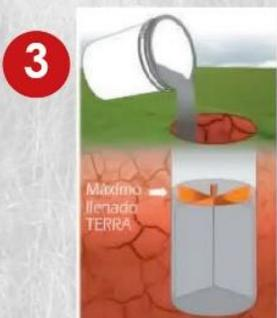
3 Proceda a vaciar la mezcla del TERRA-ENV que preparo, rodeando el electrodo desde el fondo de la perforación hasta que el nivel del TERRA cubra o lo menos la mitad del electrodo.
