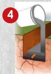
4 En cepas donde se guía el cable desnudo (malla o anillo de tierras), aplicar una capa de 5cm de intensificador TERRA-ENV, antes de tender el cable y otra capa de 5cm de intensificador TERRA-ENV despues de tender el cable.
