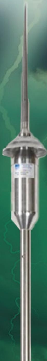
El avance de cebado del Active 1D se obtiene por un dispositivo denominado "dispositivo de impulsión". Su principio consiste en almacenar la energía electrostática presente en la atmósfera cuando se acerca una nube tormentosa, para generar el cebado de la descarga ascendente en el momento oportuno.
