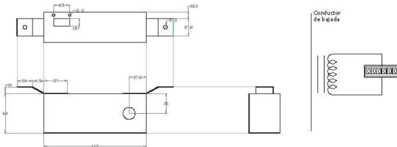
El contador de rayos CR 1000 esta diseñado para contabilizar impactos de rayos en un sistema de protección exterior.
