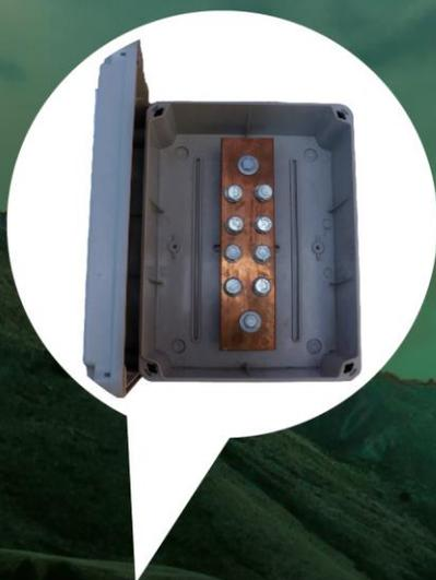
Producimos caja equipotenciales para compensación del potencial para puesta a tierra con barra de conexión formada por pletina y bornes de conexión y aisladores para su fijación. Es utilizada para disminuir los riesgos de daño por presencia de gradiente de potencial entre todos los equipos electrónicos.
